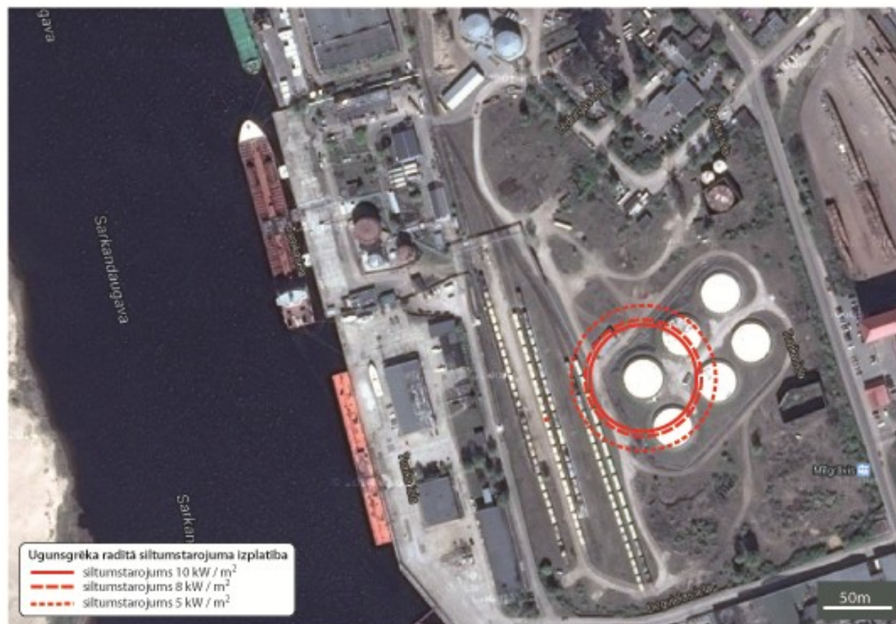
9. attēls. Siltumstarojuma ietekmes izplatība benzīna noplūdei no 3000 m 3 rezervuāra
